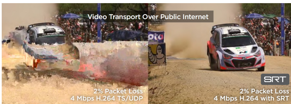
Figur 9: Samma videoström över UDP och SRT vid en paketförlust på 2%
