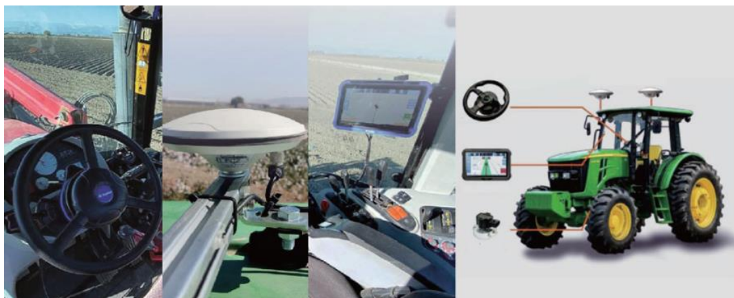
Figur 3.2 Bild på hur AG precisions system är installerade och hur de används.
