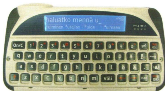
Bild 3. Kommunikationsapparat med tangentbord och inbyggd ordbok
