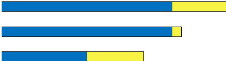
Figur 1: Översta stapeln avbildar totala kör tiden som exemplet normalt kräver. I den mellersta stapeln har tiden för delproblem b förkortats genom parallellisering. I nedersta stapeln har a 's körningstid halverats på samma sätt.
