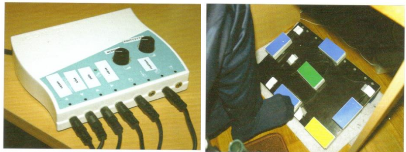
Bild 5. Icon III - musadapter(vänster) till vilken man har kopplat LT Switch-strömbrytare (höger)
